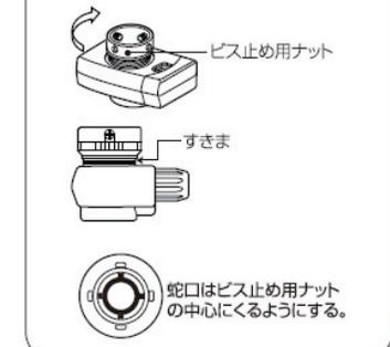
蛇口に分岐栓本体を下から強く押してながら、ビスを均等に締め付ける。
