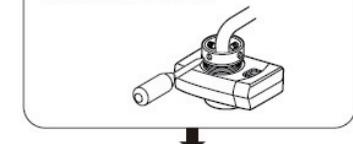
分岐栓本体をビス止め用ナットで締め付けて固定する。
