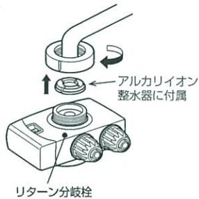
2 ホース締付けキャップをはずし、整水器本体の給水ホースに通してください。
