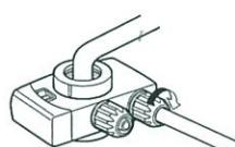
5 整水器本体のデリバリーパイプをはずし、替わりにリターンジョイントを根元までねじ込んでください。
