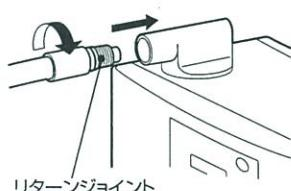
6 ホース締付けキャップをリターン分岐栓からはずし、リターンホースに通してください。
