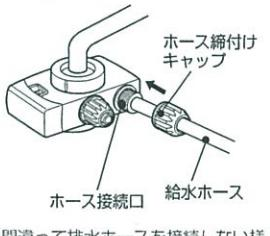
4 ホース締付けキャップを締め付けてください。
