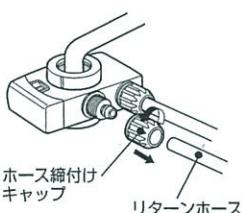
7 リターンホースをホース接続口に根元まで差し込んで、キャップを締め付けてください。
