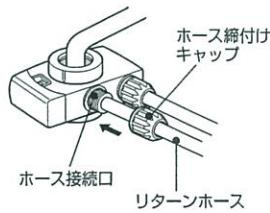
8 イオン水・浄水、水道水切替レバーを「イオン水・浄水」側にして、水道のコックを開き、リターン分岐栓から水が出ることをご確認ください。
